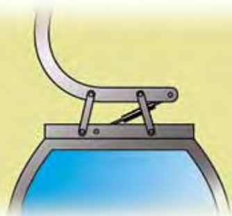
Mouvement de balancement freiné par un contrôleur de vitesse hydraulique
